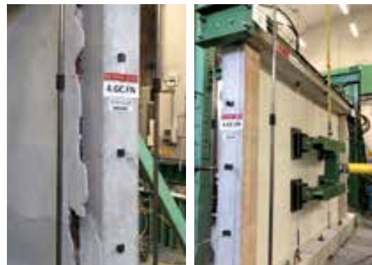
PROVE COMBinate NEL PIANO E FUORI DAL PIANO DI TAMPONATURE RINFORZATE
